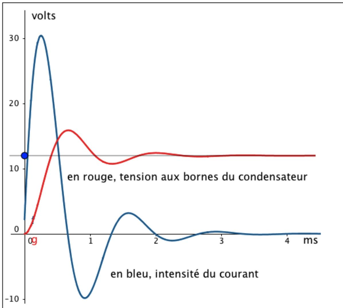
On constate qu'après 4 ms, il n'y a plus de courant dans le circuit et la charge du condensateur est stabilisée à 12 volts.
