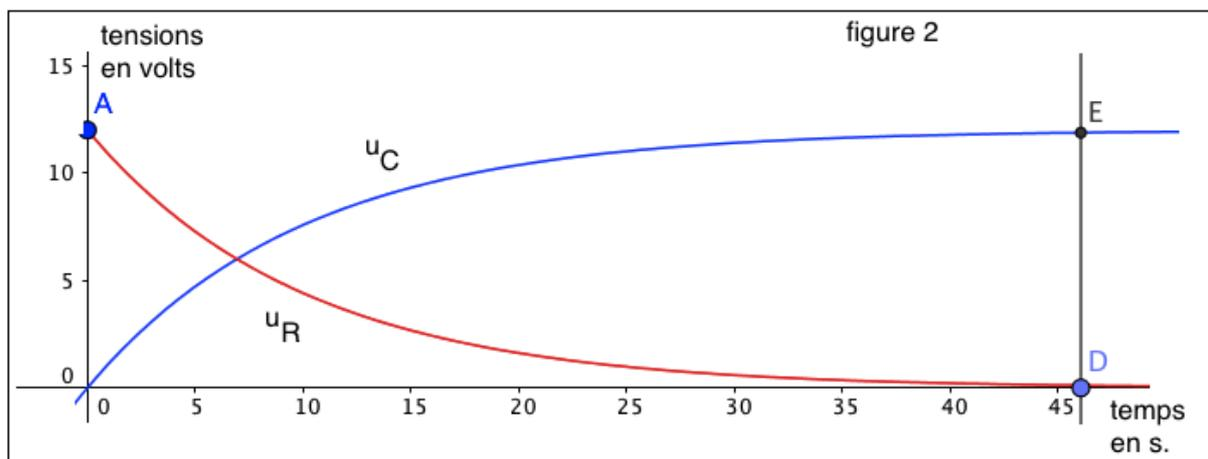
La courbe représentative de l'intensité est de même forme que celle de la tension aux bornes de la résistance, et la courbe représentative de la charge est de même forme que celle de la tension aux bornes du condensateur, comme l'indiquent leurs équations respectives.
