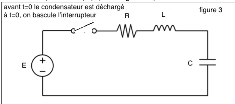
On met les 3 composants en série et on ferme le circuit sur un générateur continu de 12 V de f.e.m. On se propose de calculer en fonction du temps la tension aux bornes du condensateur  $u_C(t) = q(t)/C$ .
